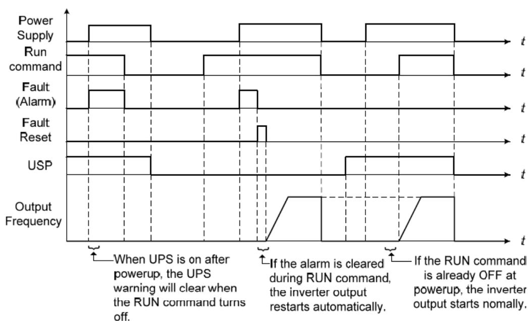
圖 4.3. 29 送電後直接運轉保護範例
