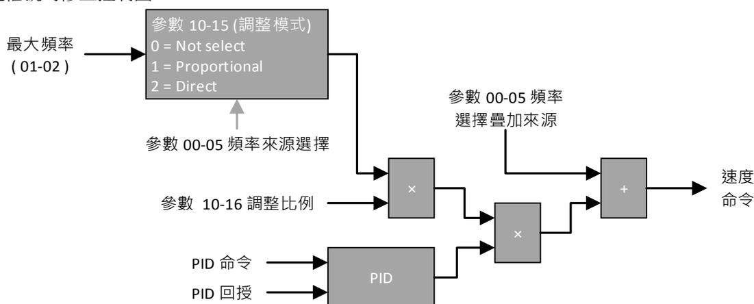
圖 4.3. 111 給定信號的修正控制圖
