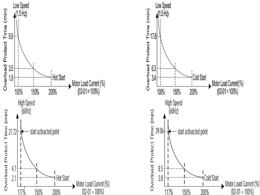
圖 4.3. 94 馬達過載保護曲線(標準馬達範例)
