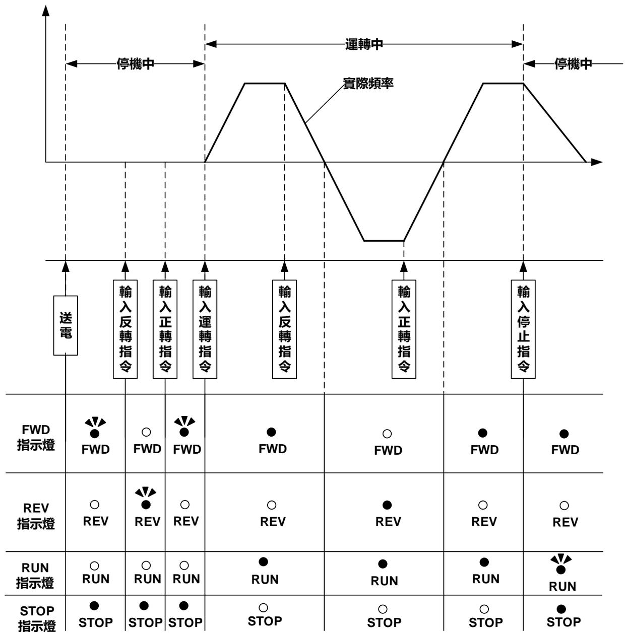
\* RUN/STOP 指示燈僅 LCD 型有
