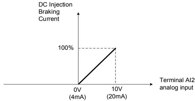
圖 4.3. 62 直流剎車電流調整
