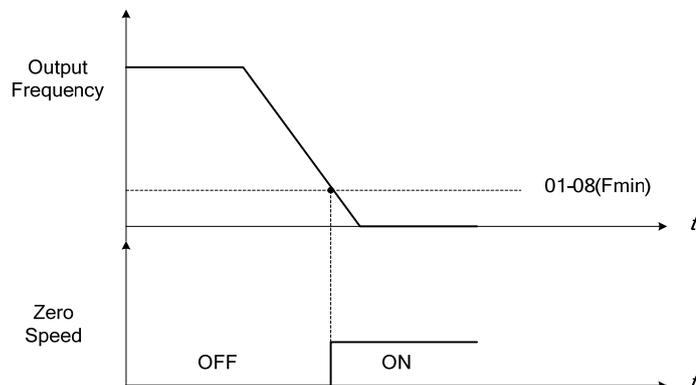
圖 4.3.33 零速度操作
