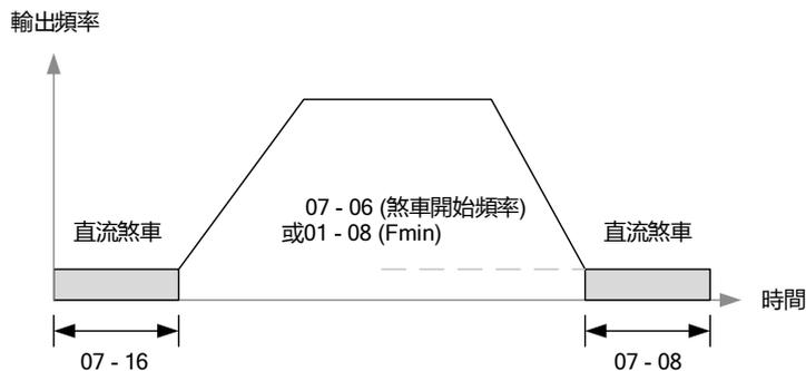
圖 4.3.77 VF、VF+PG、SLV 與 SLV2 的煞車動作
