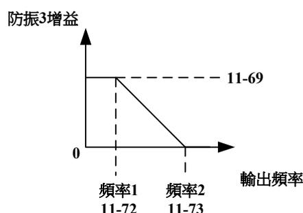
圖 4.3. 131 防止振盪增益切換頻率設定
