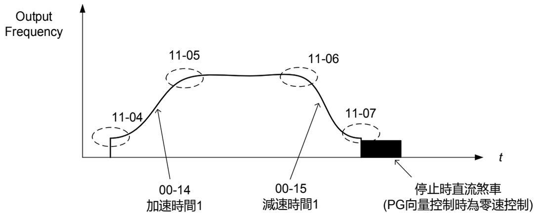
備註:在低速減速 S 曲線特性時間中，輸出頻率未達到 01-08 馬達 1 最小輸出頻率的設定值時，S 曲線特性會被中止，變為停止直流煞車(零速控制)。
