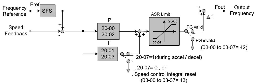
圖 4.3.148 速度控制架構(V/F + PG)
