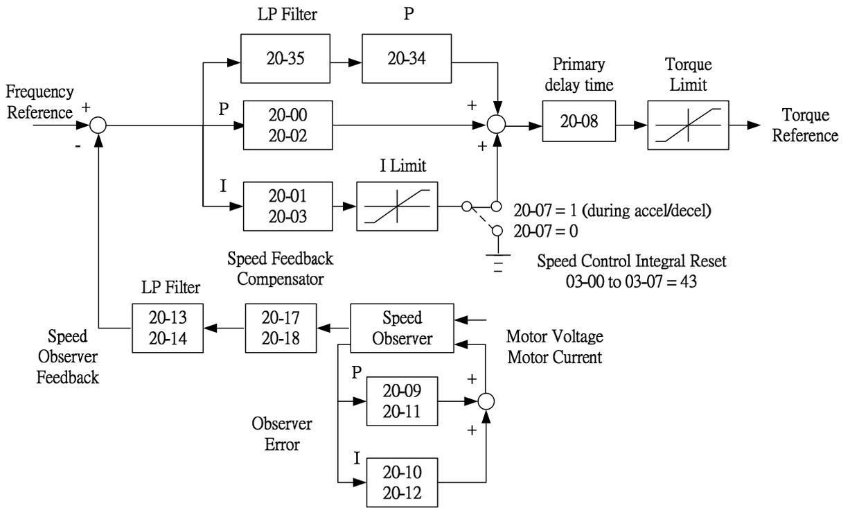
圖 4.3. 149 速度控制架構(SLV 模式)
