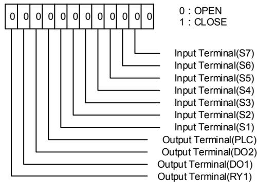
圖 4.3.133 LCD 面板顯示範例
