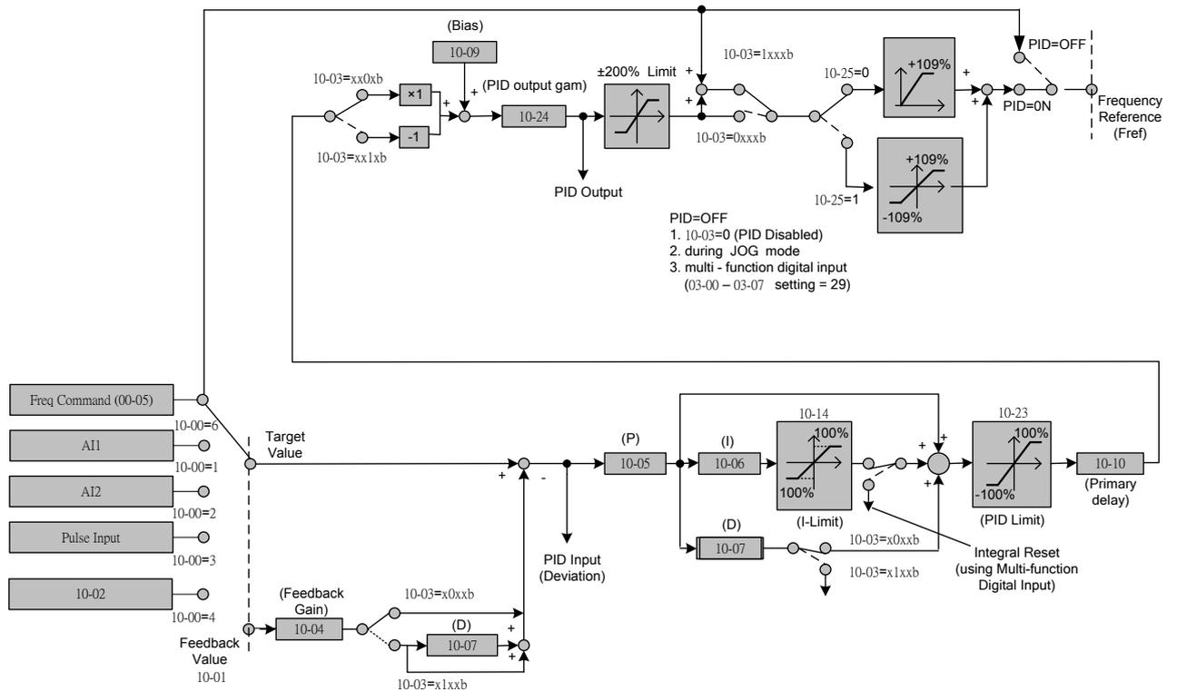
圖 4.3. 107 PID 控制方塊圖
