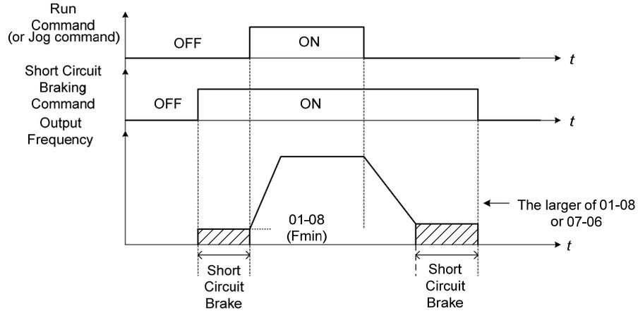
圖 4.3. 30 短路煞車動作時序範例
