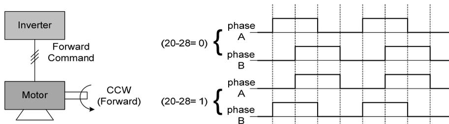
圖 4.3. 159 PG 及馬達轉動方向訊號
