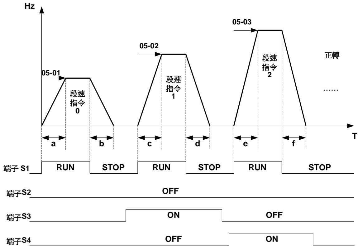
圖 4.3.70 多段速時序範例（運轉指令斷續）
