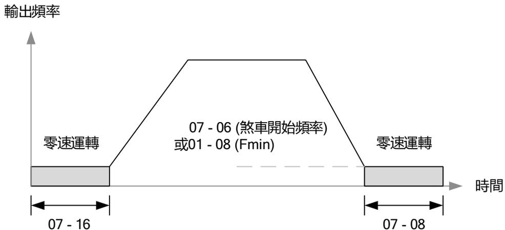
圖 4.3.79 SV 與 PMSV 的煞車動作
