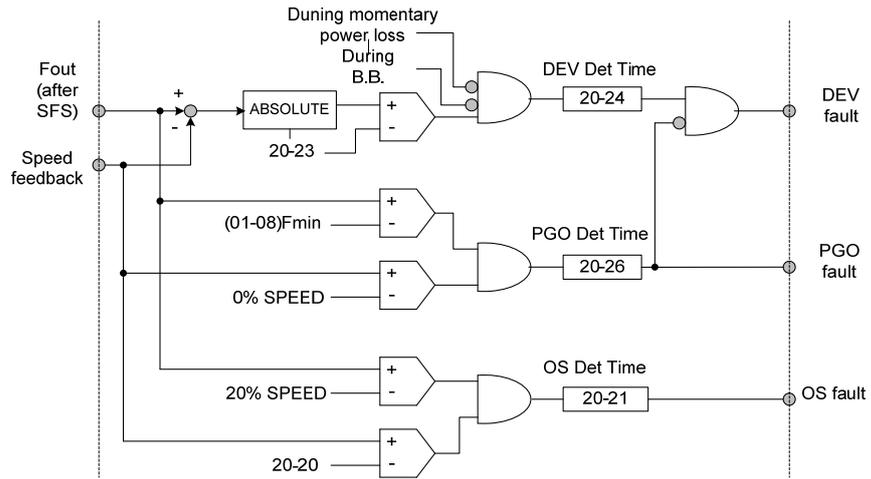
圖 4.3. 158 PG 回授故障偵測方塊圖
