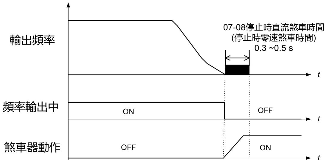
在煞車器的機械性動作較慢時，為了防止停止時的掉落，請進行直流煞車(附 PG 向量控制時為零速控制)直到煞車器完全關閉為止。
