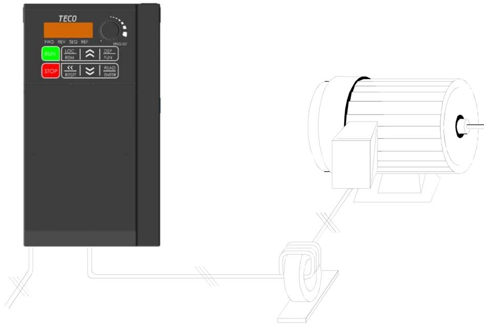
註：U,V,W 三條線需貫穿同一個 ZERO CORE，依同方向捲繞才有效果。
