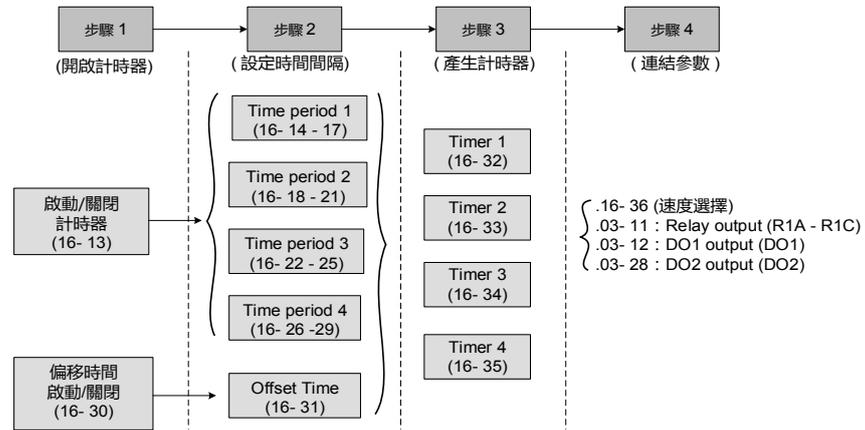
圖 4.3.136 RTC 架構
