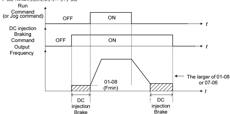
圖 4.3. 28 直流剎車時序圖
