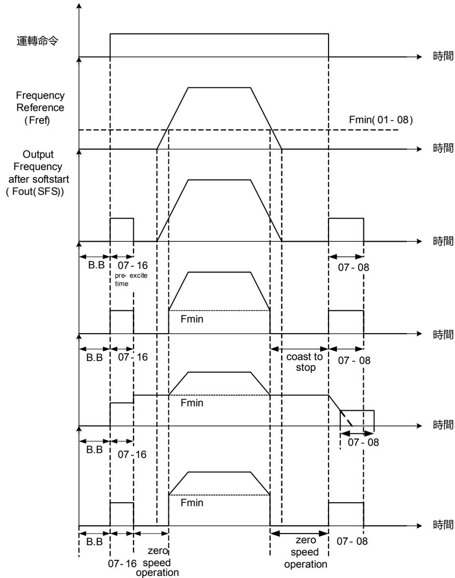
圖 4.3.13 向量控制(SV/PMSV)模式之零速度運轉
