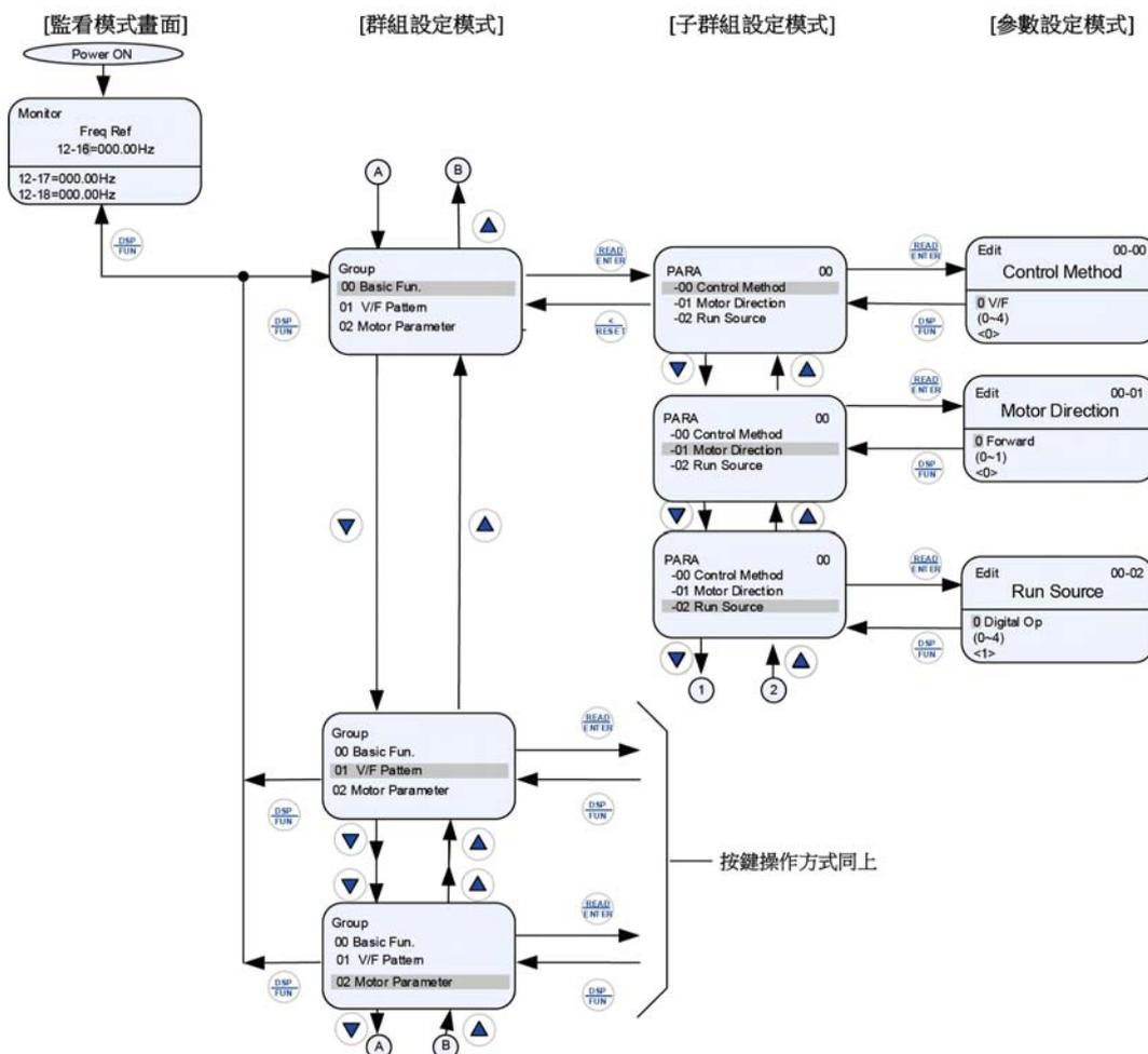
圖 4.1.9.1 進階設定的操作方式
