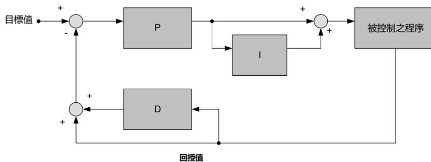
圖 4.3.104 回授微分值 PID 控制
