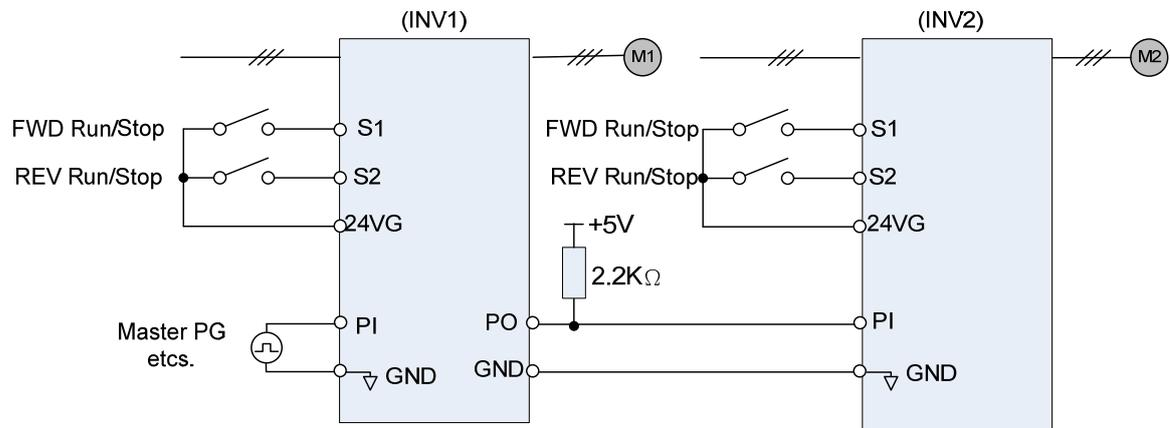
圖 4.3.46 2 個轉換器連結操作
