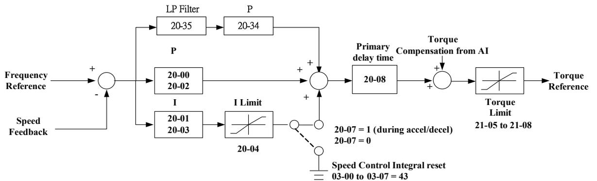
圖 4.3. 150 速度控制架構(SV 模式及 PMSV 模式)
