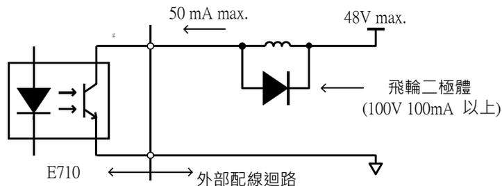
圖 3.6 光耦合輸出接點接電感性負載
