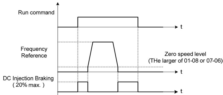
圖 4.3.125 零速度剎車操作
