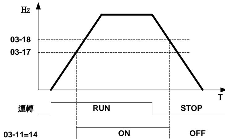
圖 4.3.36 機械煞車釋放範例(03-17≤03-18)
