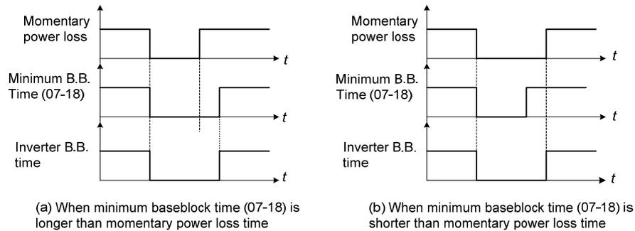
圖 4.3.85 最小 B.B 時間及瞬間功率損失時間
