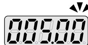
**停機狀態下：**七段顯示器顯示為設定頻率，其 LED 為全部閃爍狀態，此時若操作 UP/DOWN 鍵，即進入頻率命令修改模式，其閃爍位置依據 <</RESET 鍵而跟隨變動，按下 READ/ENTER 鍵寫入頻率命令及切換為頻率顯示模式狀態，或於頻率修改模式下經過五秒未按下 READ/ENTER 鍵即切回頻率顯示模式。
