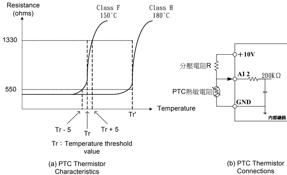
圖 4.3. 98 (a)熱敏電阻正溫度係數特性值對應溫度、(b)端子連接示意圖
