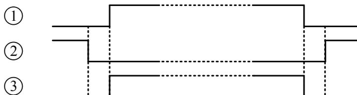
在備用電源投入前，電磁接觸器 ① 及 ③ 導通，電磁接觸器 ② 須保持斷路。電磁接觸器 ③ 必須等到電磁接觸器 ① 導通之後才能導通。當備用電源即將被移除及電磁接觸器 ② 導通之前，電磁接觸器 ① 及 ③ 必須保持斷路。
