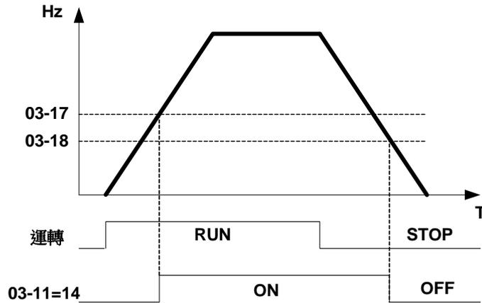
圖 4.3. 37 機械煞車釋放範例(03-17≥03-18)
