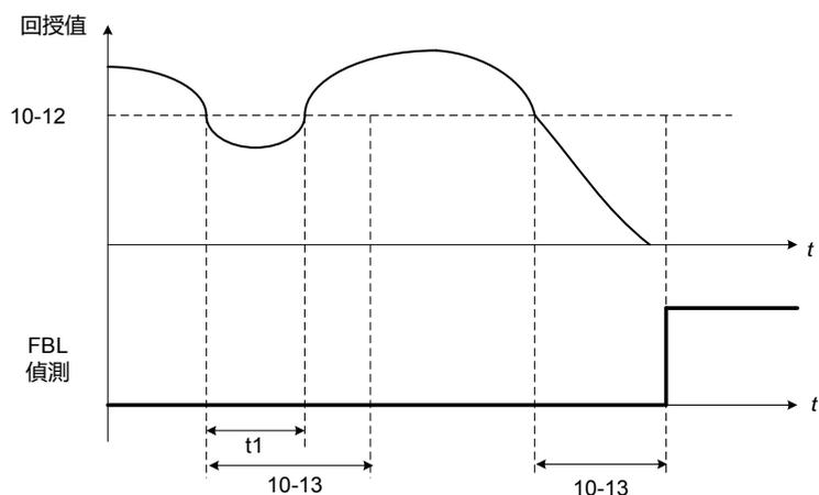
圖 4.3.108 PID 回授斷線偵測
