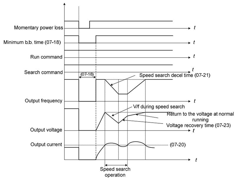
圖 4.3. 88 在瞬間停電時的速度搜尋
