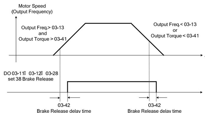
圖 4.3.50 煞車釋放機能搭配頻率到達機能使用範例
